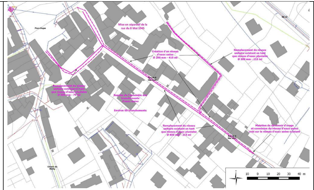
Action THU4 – Mise en séparatif rue du 8 mai 1945
